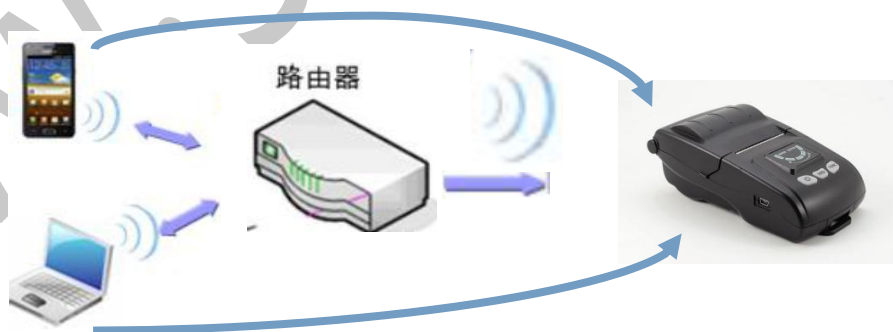
AP/STA 模式下 WiFi 打印机组网图示
