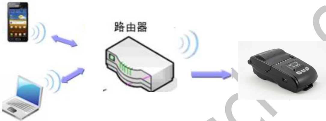
STA 模式下 WiFi 打印机组网图示
